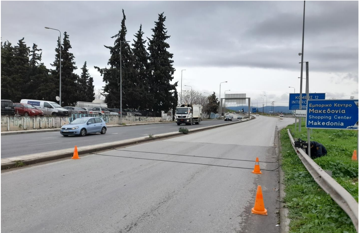
Σχήμα 4.4 Απεικόνιση των αυτόματων μετρητών κυκλοφορίας τύπου πνευματικού σωλήνα που θα χρησιμοποιηθούν για την εκπόνηση μετρήσεων σε οδικά τμήματα στο πλαίσιο του ΣΒΑΚ του Δήμου Νεάπολης- Συκεών
